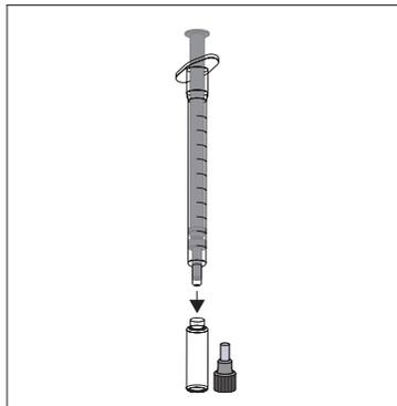
Setzen Sie nun die Spritze auf die Flasche und führen Sie vorsichtig die vollständige Probenmenge der Lösung zu.
